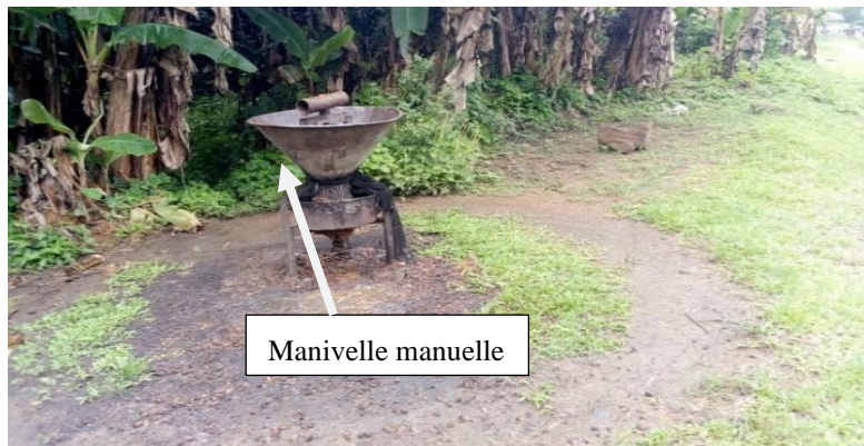
Photo 1. Installation d’une usine manuelle d’extraction d’huile de palme à Solopa et Ndjok Loubé
